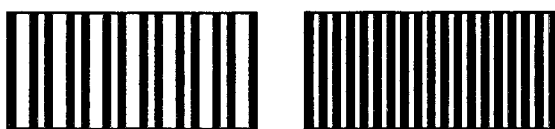
图 4 达到 200 r/min 前可以观察到的多重频闪线条
